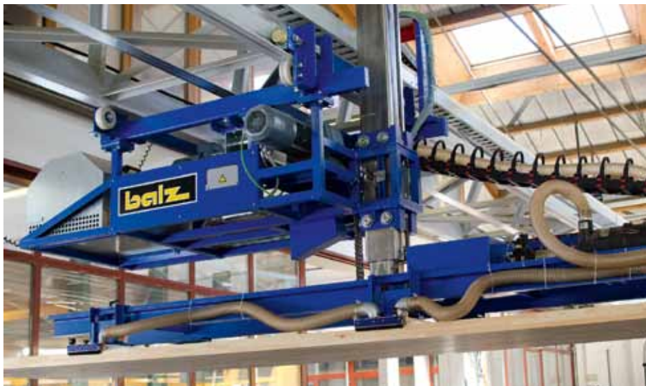
Mittels Vakuumtechnik werden die Kanteln lagenweise auf den Querförderer gehoben
