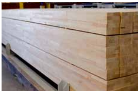
6 m lange Kanteln kann die neue Mechanisierung handlen
