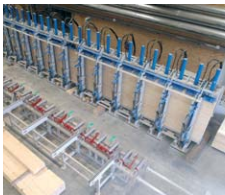
Die Verarbeitung zu Leimholz in der hydraulischen Presse ist in vollem Gange.
