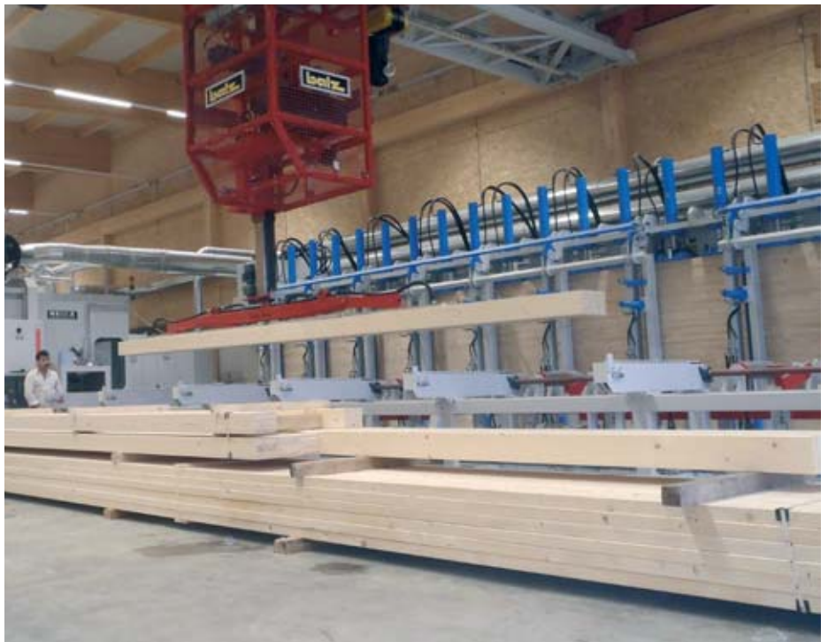
Der Vakuumsortierroboter von Balz dient zum schonenden und flexiblen Transportieren jeglicher Holzprodukte.
