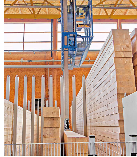
Ein Hebegerät von Balz bei der Einlagerung von Leimholzstangen in das Kommissionierlager
